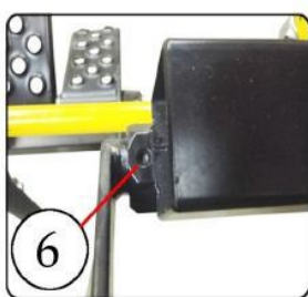
6 Смазывание подвижных точек ножного механизма поднятия нажимной балки (маслёнка)
