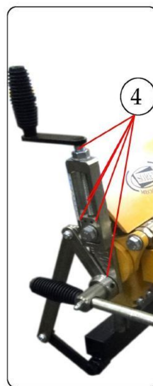
4 Смазывание подвижных точек механизма поднятия нажимной балки - типа загибание листа с четырёх сторон (маслёнка)
